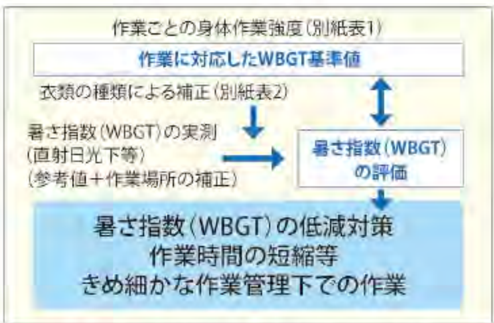
図 暑さ指数(WBGT)の評価と評価結果に基づく措置
