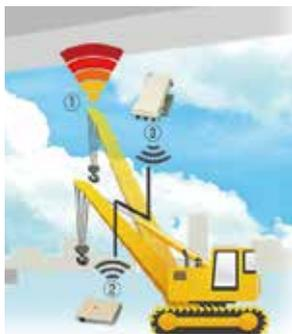
このセンサーは超音波を利用した構造物検知センサーです。
