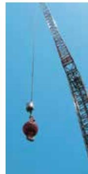
ラフテレーンクレーン向け無線式吊荷監視カメラ
